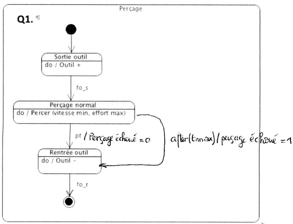
**Q2.** Modifier le diagramme de prospection en conséquence pour que, dans le cas d'un échec du perçage, le système revienne en situation initiale
