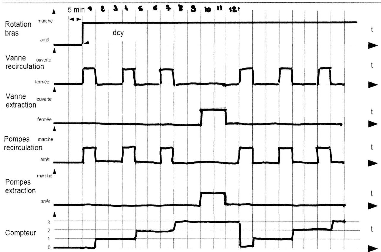
Q2. les 6 pompes de circulation fonctionnent 15' par cycle d'1h (1/4 h)
