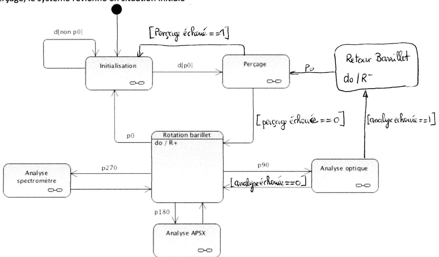
**Q4.** Poursuivre la modification du diagramme de prospection pour que, dans le cas d'un échec de l'analyse optique, la phase de perçage soit relancée
