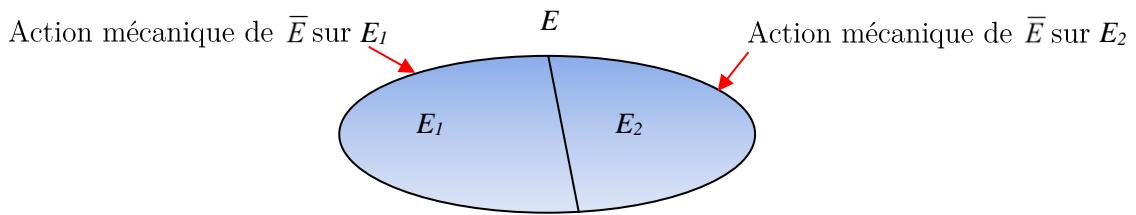
Soit une partition du système matériel  $E$  en sous-systèmes  $E_1$  et  $E_2$ , appliquons le Principe Fondamental de la Statique successivement à  $E$ ,  $E_1$  et  $E_2$  :
