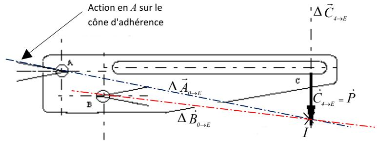
On constate que la direction de  $\Delta \vec{B}_{0 \rightarrow E}$  est contenue dans le cône d'adhérence en  $B$ : le Système matériel  $E$  est donc en équilibre. De plus cet équilibre est indépendant de la valeur de  $\vec{C}_{4 \rightarrow E} = \vec{P}$ , c'est le phénomène de l'arc-boutement.
