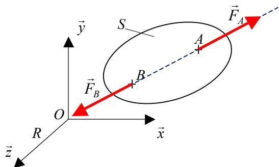
Soit un solide  $S$  en équilibre par rapport à un repère galiléen  $R(O; \vec{x}, \vec{y}, \vec{z})$  soumis à l'action de deux forces modélisées par les torseurs suivants :
