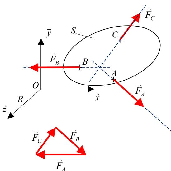
Soit le solide  $S$  en équilibre par rapport à un repère galiléen  $R(O; \vec{x}, \vec{y}, \vec{z})$  sous l'action de trois forces modélisées par les torseurs suivants :
