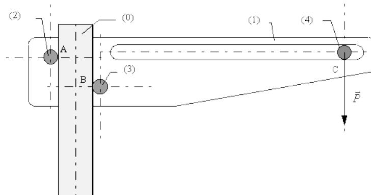
Supposons que ce système matériel  $E$  soit en équilibre sous l'action des A.M. exercées par les solides (0) et (4). On supposera que les poids propres des solides sont négligeables devant les autres efforts. On connaît les coefficients d'adhérence en A et B :  $f_A = f_B = 0.18$
