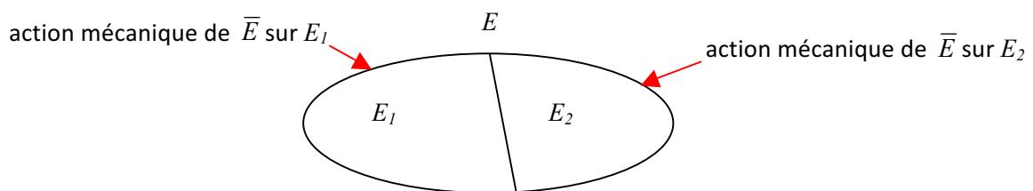
Soit une partition du système matériel  $E$  en sous systèmes  $E_1$  et  $E_2$ , appliquons le Principe Fondamental de la Statique successivement à  $E$ ,  $E_1$  et  $E_2$  :
