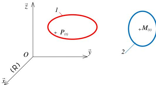
Soit un point  $P$  d'un solide  $1$  en mouvement par rapport à un repère  $R$ . Ce point appartient naturellement au solide  $1$ , c'est à dire qu'à chaque instant il est lié au solide. Les écritures :  $\vec{V}_{P \in 1/R}$  et  $\vec{a}_{P \in 1/R}$  sont interprétées de façon évidente.
