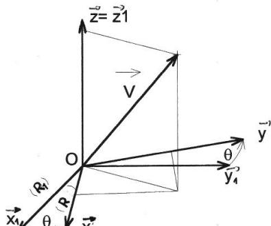
Dans ce cas, un seul paramètre angulaire suffit pour orienter la base de  $R$  par rapport à la base de  $R_I$ .
