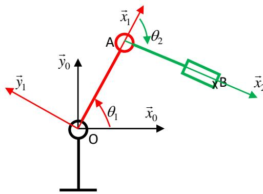
On considère un modèle plan simple dans lequel pistolet de peinture du robot est animé par seulement deux mouvements de rotation de paramètres  $\theta_1$  et  $\theta_2$ .
