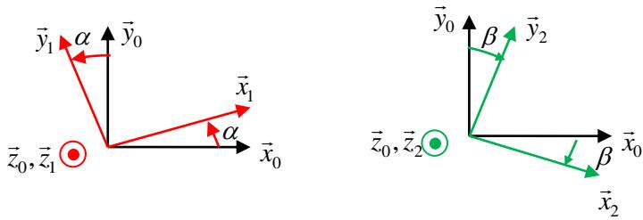
Le paramètre d'entrée est  $\alpha$ , il traduit la rotation de la *manivelle 1* par rapport à  $O$  autour de l'axe  $(O; \vec{z}_0)$ . Le paramètre de sortie est  $x$ , il traduit la translation du *piston 3* par rapport à  $O$  suivant l'axe  $(O; \vec{x}_0)$ . Le paramètre  $\beta$  est un paramètre intermédiaire qui traduit la rotation de la bielle 2 par rapport à  $O$  autour de l'axe  $(B; \vec{z}_0)$ .
