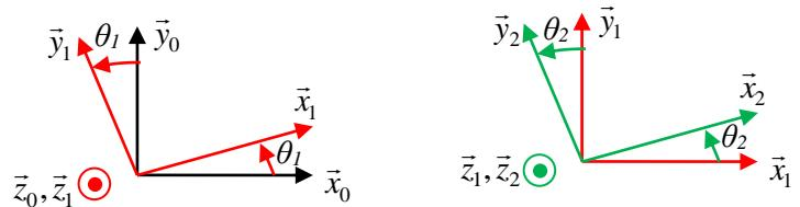
Remarque : En composant pièces et liaisons successives, on obtient la position angulaire de la pièce  $n$  en bout de chaîne par rapport à la pièce liée au bâti 0 :  $(\vec{z}_0, \vec{z}_n) = (\vec{z}_0, \vec{z}_1) + (\vec{z}_1, \vec{z}_2) + \dots + (\vec{z}_{n-1}, \vec{z}_n)$
